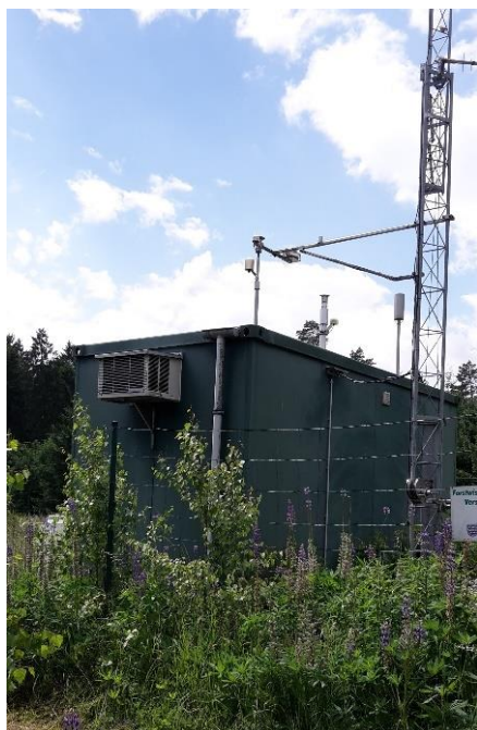
Bild 2: Messcontainer im Freiland der HMS Holzland zur Messung von meteorologischen Komponenten (Niederschlag, Temperatur, Luftfeuchte, Windgeschwindigkeit, Windrichtung, Globalstrahlung) sowie Luftschadstoffen (Schwefeldioxid, Stickoxide, Ozon)
