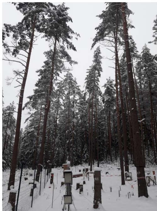
Bild 2: Messcontainer im Freiland der HMS Holzland zur Messung von meteorologischen Komponenten (Niederschlag, Temperatur, Luftfeuchte, Windgeschwindigkeit, Windrichtung, Globalstrahlung) sowie Luftschadstoffen (Schwefeldioxid, Stickoxide, Ozon)
