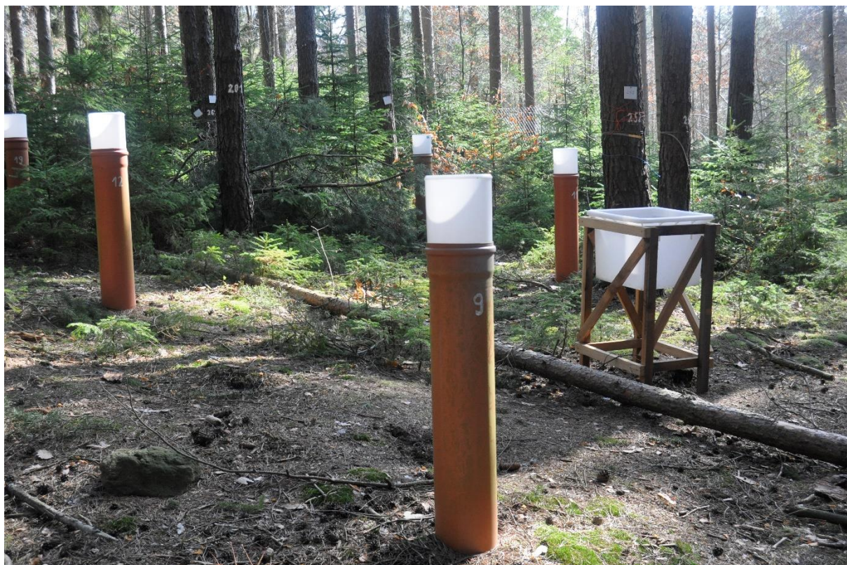
Bild 1: Niederschlagssammler und Streusammler an der Hauptmessstation Holzland
